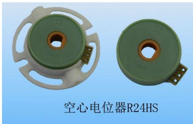
R24HS 中空轴旋转型导电塑料电位器装配简单，易于安装到任何旋转位置，外形尺寸为Φ 24mm，其内部采用导电塑料电阻基片，可用于信号的设定和反馈。
